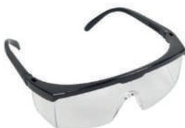
O Óculos de Segurança Jaguar Incolor, constituídos de arco de material plástico (náilon) com meia-proteção nas bordas, um pino central e duas fendas nas extremidades da armação utilizadas para o encaixe de visor confeccionado em policarbonato com um furo central para encaixe do pino do arco, apoio nasal e protetor lateral injetado do mesmo material do visor.
