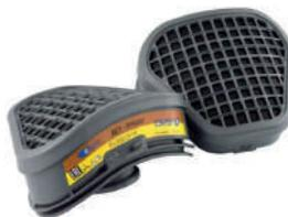
Cada respirador é fornecido com dois filtros de gás ou cartuchos combinados de gás e partículas para a proteção contra uma variedade de gases, vapores, poeira e névoas. Quando os cartuchos estiverem saturados, eles poderão ser substituídos por filtros de substituição que oferecem proteção versátil contra substâncias em concentrações de até 5.000 ppm e de poeira e névoas até 50 TLV.
