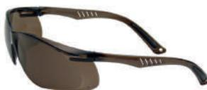
Óculos de segurança constituído de armação e visor em policarbonato. As hastes do tipo espátula são confeccionadas do mesmo material da armação, borracha preta maleável na parte central da ponta das hastes e são fixadas às extremidades do visor através de parafusos metálicos.
